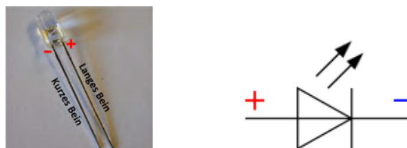
Abbildung 2: Leuchtdiode: Bauelement (links) und Schaltungssymbol (rechts)
